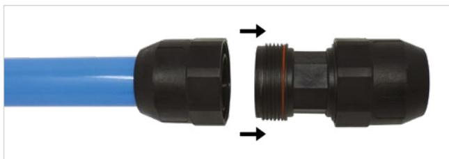
Il sistema F-Line.PRO è stato studiato per facilitare al massimo le operazioni di manutenzione ed ampliamento. È possibile disconnettere il tubo dal raccordo semplicemente svitando la ghiera nel caso in cui sia poi necessario riconnettere il medesimo tubo nella stessa posizione.
