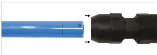
Il sistema F-Line.PRO per diametro 20, 25 e 40 è ad innesto rapido. Inserire il tubo nel raccordo **SENZA** svitare la ghiera (verificare che il raccordo sia stato fornito con ghiera completamente avvitata prima della connessione: il testimone di avvitamento non deve essere visibile). Al fine di agevolare l'inserimento, centrare il tubo rispetto alla guarnizione e, successivamente, effettuare il completo inserimento.
