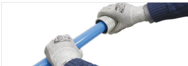
Sbavare sempre il tubo, esternamente ed internamente, eliminando gli spigoli vivi, prima di effettuare la connessione con i raccordi. Utilizzare l'accessorio FPUS.
