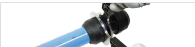
Successivamente, completare la fase di serraggio tramite l'utilizzo delle relative FPCH e FPCCH accertandosi di coprire con la ghiera il testimone di avvitamento arancione presente sul corpo del raccordo.
