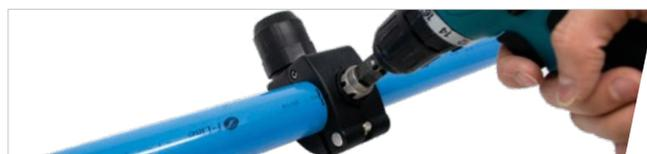
Una volta segnato il tubo e individuato il centro del foro, rimuovere la dima di centraggio e utilizzare la fresa per completare la foratura del tubo, avendo cura di non urtare la parete opposta del tubo con la punta della fresa.
