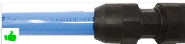
Verificare il corretto inserimento mediante riscontro della marcatura precedentemente effettuata sul tubo rispetto alla ghiera del raccordo (il segno dovrà trovarsi in prossimità dell'estremità della ghiera).
