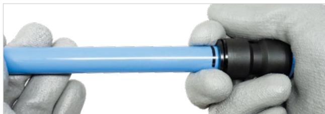
Schiacciare il colletto nero posizionato nella parte terminale del raccordo e, tenendolo premuto, tirare longitudinalmente il tubo, senza inclinarlo all'interno del raccordo.
