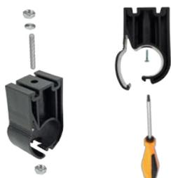
Tutti i fermatubo a parete possono essere installati utilizzando un dado esagonale M8 da inserire all'interno dell'FPST (utilizzando una barra filettata). E' inoltre possibile utilizzare viti autofilettanti con tassello ad espansione nel caso di fissaggio su muratura o calcestruzzo.
