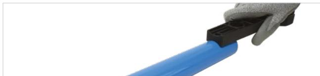
Marcare il tubo utilizzando il calettometro che si trova sull'impugnatura dell'apposita chiave (FPCH) di serraggio al fine di poter identificare il corretto e completo inserimento del tubo nel raccordo.
