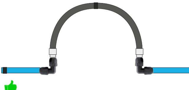
Questa è l'applicazione corretta dell'installazione del giunto di dilatazione. Deve essere rivolto verso l'alto e con due raccordi a gomito allineati. Inoltre bisogna inserire due clip fermatubo sulla tubazione in alluminio in prossimità dell'installazione di un giunto di dilatazione.
