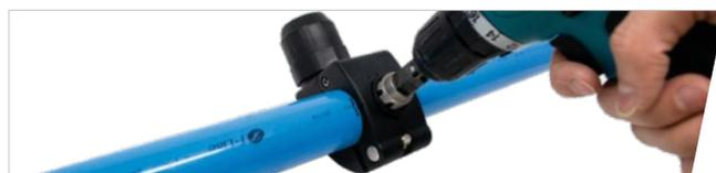
Una volta segnato il tubo e individuato il centro del foro, rimuovere la dima di centraggio e utilizzare la fresa per completare la foratura del tubo, avendo cura di non urtare la parete opposta del tubo con la punta della fresa.
