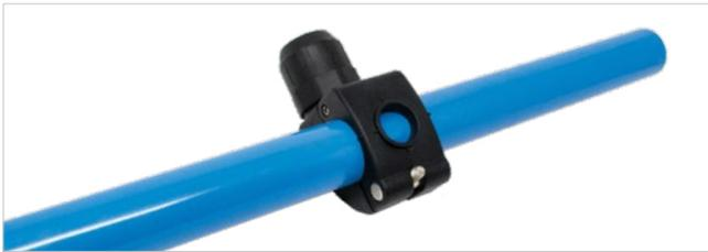
Posizionare la presa di derivazione rapida al contrario della sua posizione finale di installazione. Utilizzare il marcatore sul corpo per centrarlo correttamente sul tubo.
