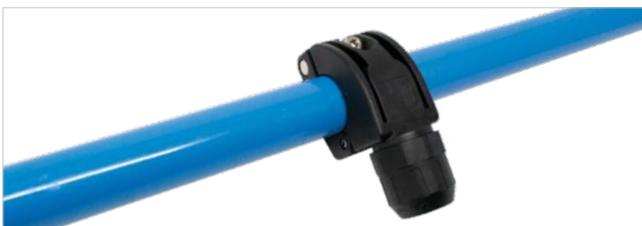
Fissare la presa in modo che la parte interna rimanga correttamente nel foro. Le prese di derivazione rapida F-Line.PRO hanno una presa d'aria guidata che va all'interno del tubo in modo che, una volta fissati, sarà impossibile che si muovano dalla loro posizione. Questo sistema ne assicura il funzionamento, garantendo sempre il massimo flusso d'aria ed eliminando il rischio di perdite.
