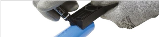
Il sistema F-Line.PRO è ad innesto rapido. Inserire il tubo nel raccordo **SENZA** svitare la ghiera (verificare che il raccordo sia stato fornito con ghiera completamente avvitata prima della connessione: il testimone di avvitamento non deve essere visibile). Al fine di agevolare l'inserimento, centrare il tubo rispetto alla guarnizione e, successivamente, effettuare il completo inserimento.
